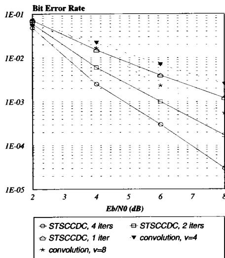
그림 6. DS-CDMA 시스템에서의 STSCCDC와 Convolution 부호의 BER 성능
