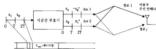
그림 2. 시공간 블록 부호를 이용한 전송 다이버시티 기법
