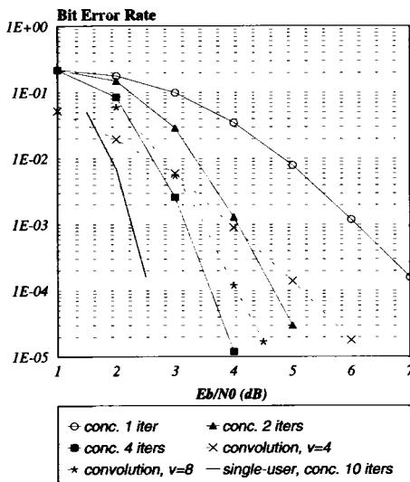
그림 5. DS-CDMA 시스템에서의 STSCCDC와 Convolution 부호의 BER 성능
