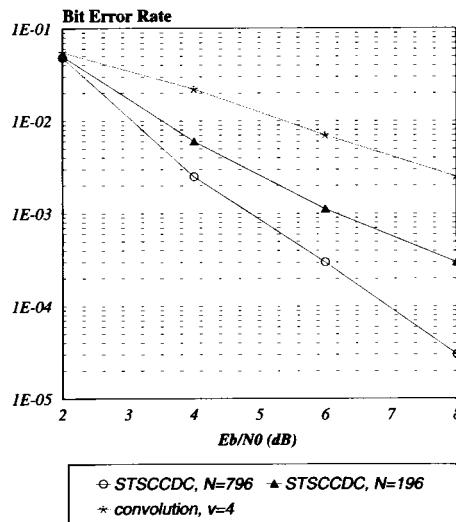
그림 7. 다른 프레임 크기에 따른 STSCCDC와 Convolution 부호의 BER 성능 (ITU-R)
